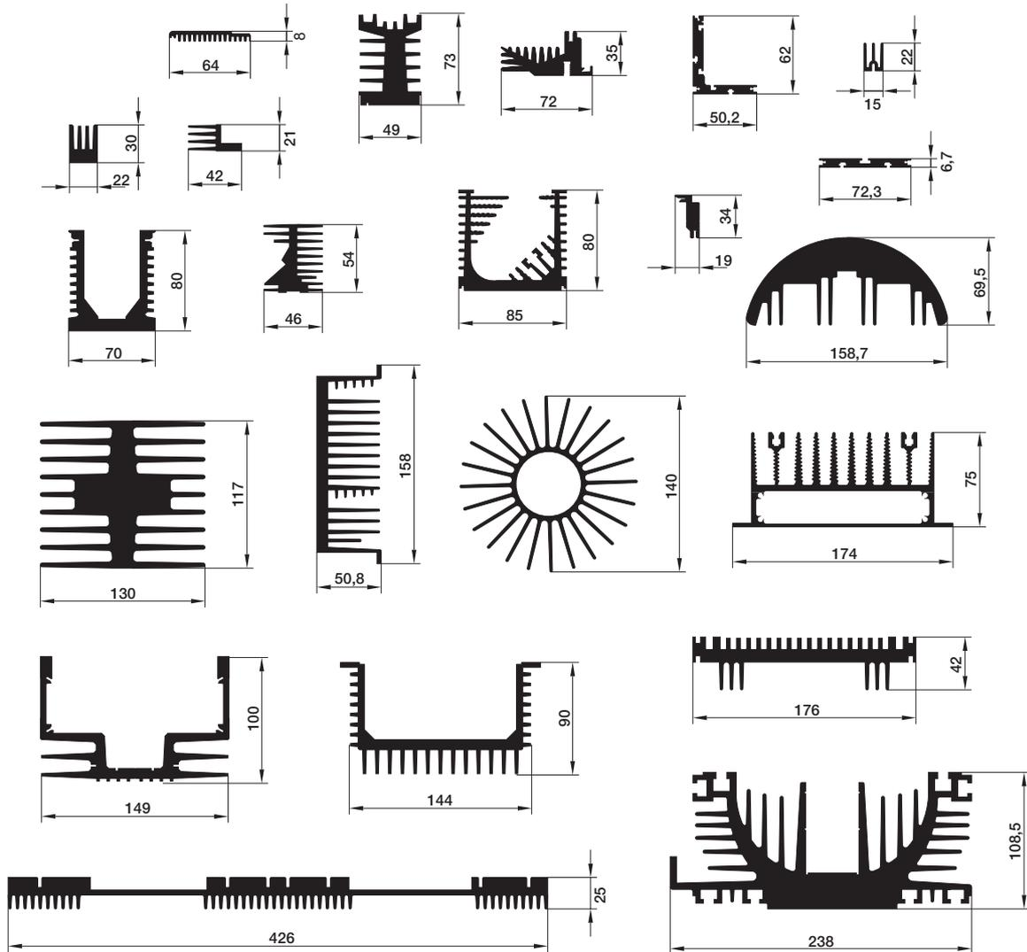
Wir entwickeln und fertigen kundennah maßgeschneiderte Kühlkörper-Lösungen. Auf dieser Seite stellen wir einen Auszug aus dem umfangreichen Sortiment an Sonderprofilen dar.
