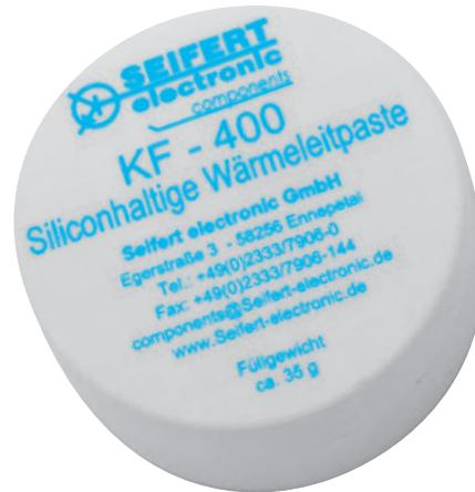
Die Wärmeleitpaste KF-400 ist eine bis zu 200°C hitzebeständige, vaselineartige Paste mit guter Wärmeleitfähigkeit. Sie ist bei hohem Reinheitsgrad chemisch neutral und konsistenzbeständig bei hohen und niedrigen Temperaturen. KF-400 gleicht für den Wärmefluss alle Unebenheiten innerhalb der Berührungsfläche zwischen Halbleiter und Kühlkörper aus und sichert damit bei laufender Fertigung gleichbleibende Wärmeübergangszahlen.
